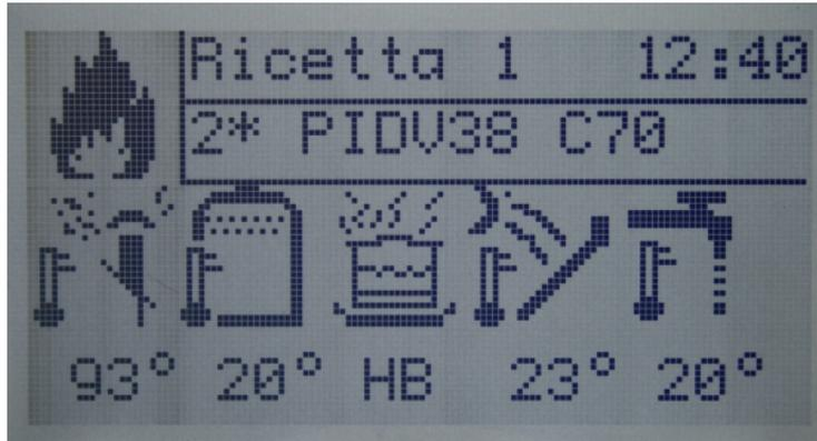
El display gráfico indica el estado de funcionamiento actual de la caldera, la visualización es efectuada por medio de simples iconos que informan del valor leído por los sensores y asociado a la función solicitada.
