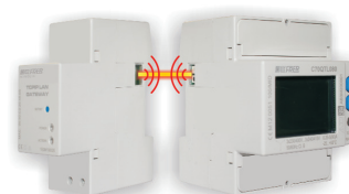
porta ottica IR - optical port (IR)
